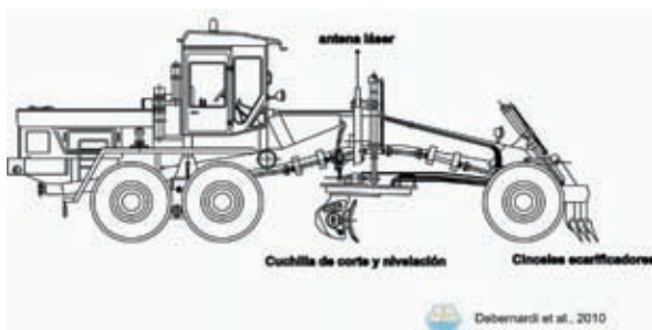
Fig. 21. Equipo de nivelación, Motoconformadora con equipo de nivelación láser.
