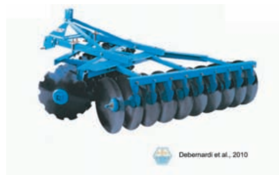
Fig. 20. Rastra portada ligera de 20 discos equipada con sistema de acoplamiento de tres puntos.
